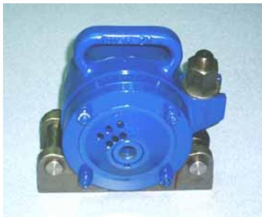
センターシャフトの周りを大小2個の円筒ローターが回転して大きな振動を発生する。コンクリート、モルタル等の2次製品、耐火材の脱泡、充填に適しています。
